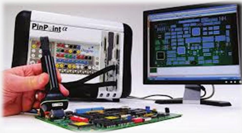
基板のコーティング除去を行い、「PinPoint Σ」によって不良箇所を的確に解析。迅速な基板修理はもちろん、回路図作成や基板再設計の際にも威力を発揮します。
